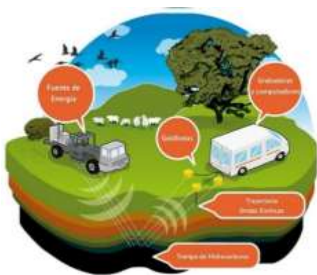
Imagen 2. Exploración sísmica de reflexión Fuente. ANH.
